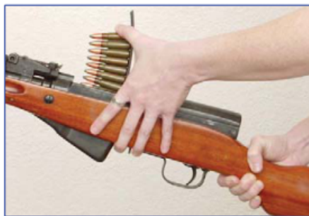
Hình 4-46. Lắp kẹp đạn vào súng
