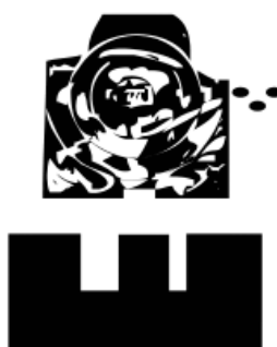
Hình 5-5. Chính giữa đỉnh đầu ngắm lệch phải so với điểm chính giữa mép trên khe ngắm.
