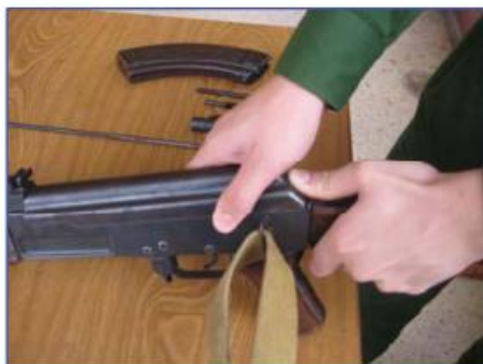
Hình 4-24. Tháo nắp hộp khoá nòng.
