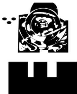
Hình 5-4. Chính giữa đỉnh đầu ngắm lệch trái so với điểm chính giữa mép trên khe ngắm.
